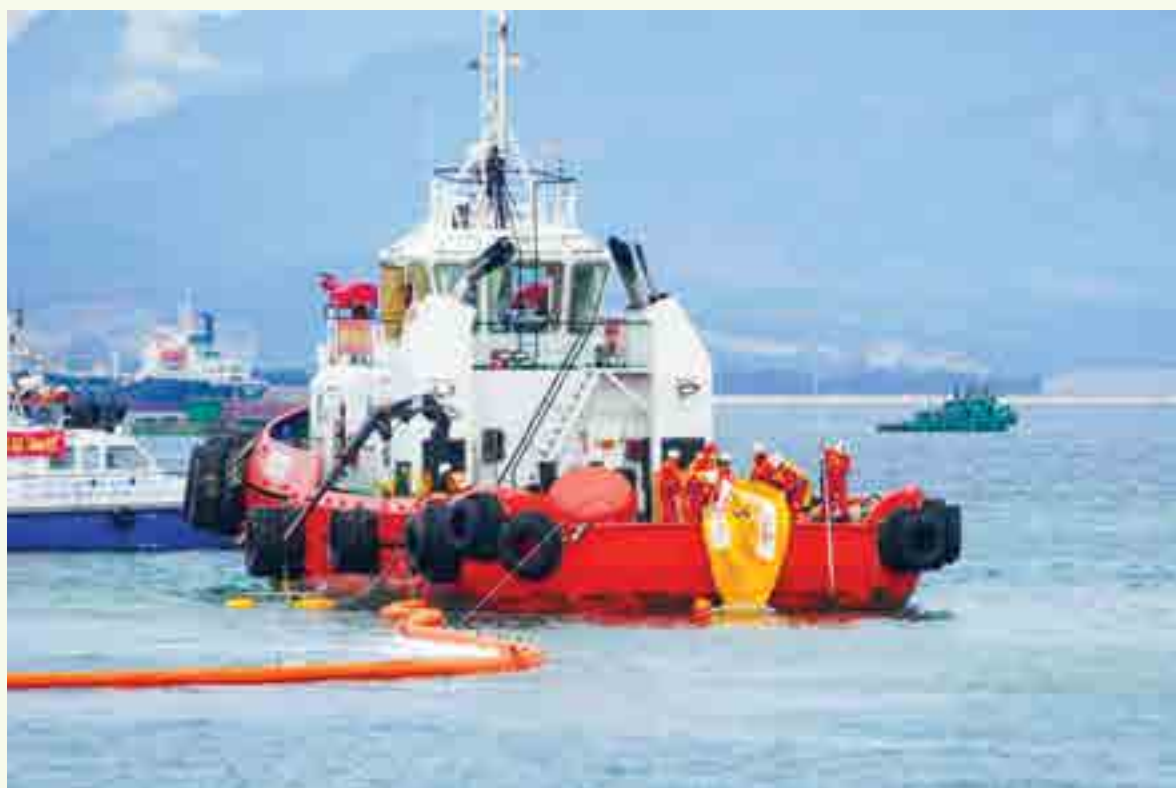
Lực lượng cứu hộ của BSR, PTSC Quảng Ngãi triển khai thả skimmer (bơm hút chân không) để thu gom dầu nổi trên mặt biển
